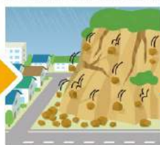
● 小石がぼろぼろ落下 ● 亀裂の発生
